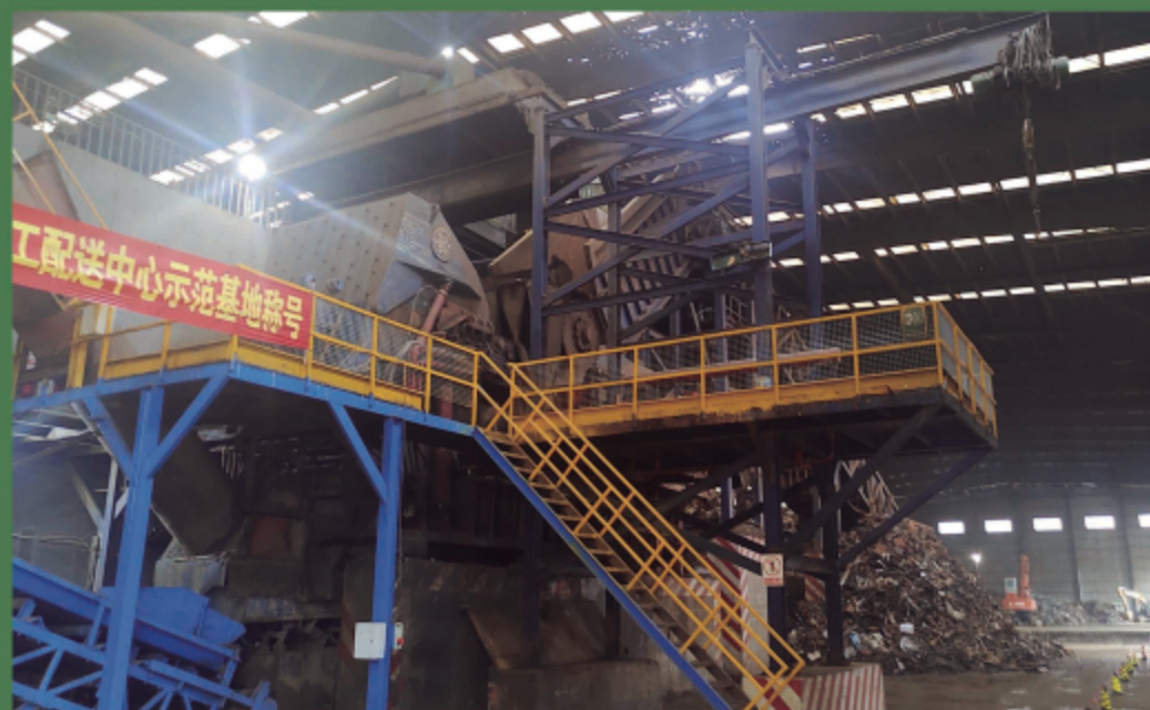
2010年，张家港华仁引进了一条美国纽维尔6000HP废钢破碎线，自设备投产以来每年稳定高效运行超过300天。
