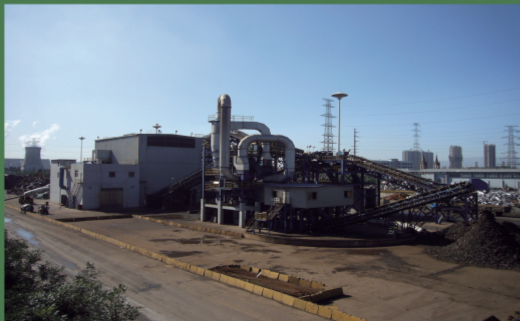
山西太钢投产的10000匹马力纽维尔多功能破碎机系统，既可以破碎普通废钢，又可以达到生产不锈钢降温炉料的功能，为客户节省了一套破碎系统的投资。
